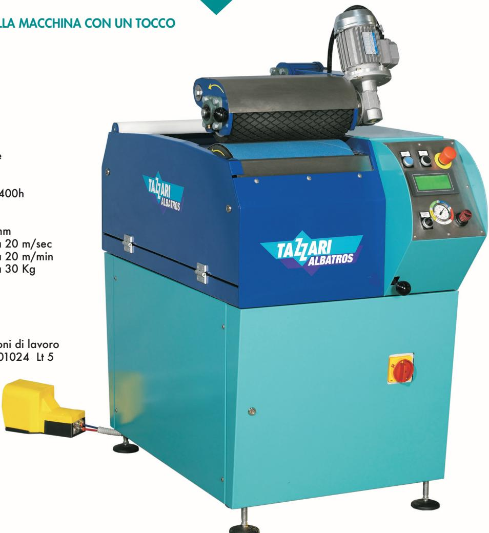
▶ Levigatrice professionale a nastro per la sgrossatura, la finitura e la lappatura di sci e snow board.
